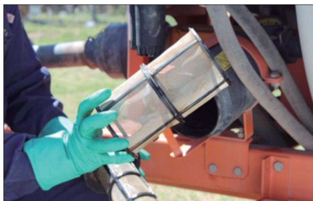
Figura 4. Revisión de estado de filtro principal en un pulverizador, como parte del proceso de inspección.
