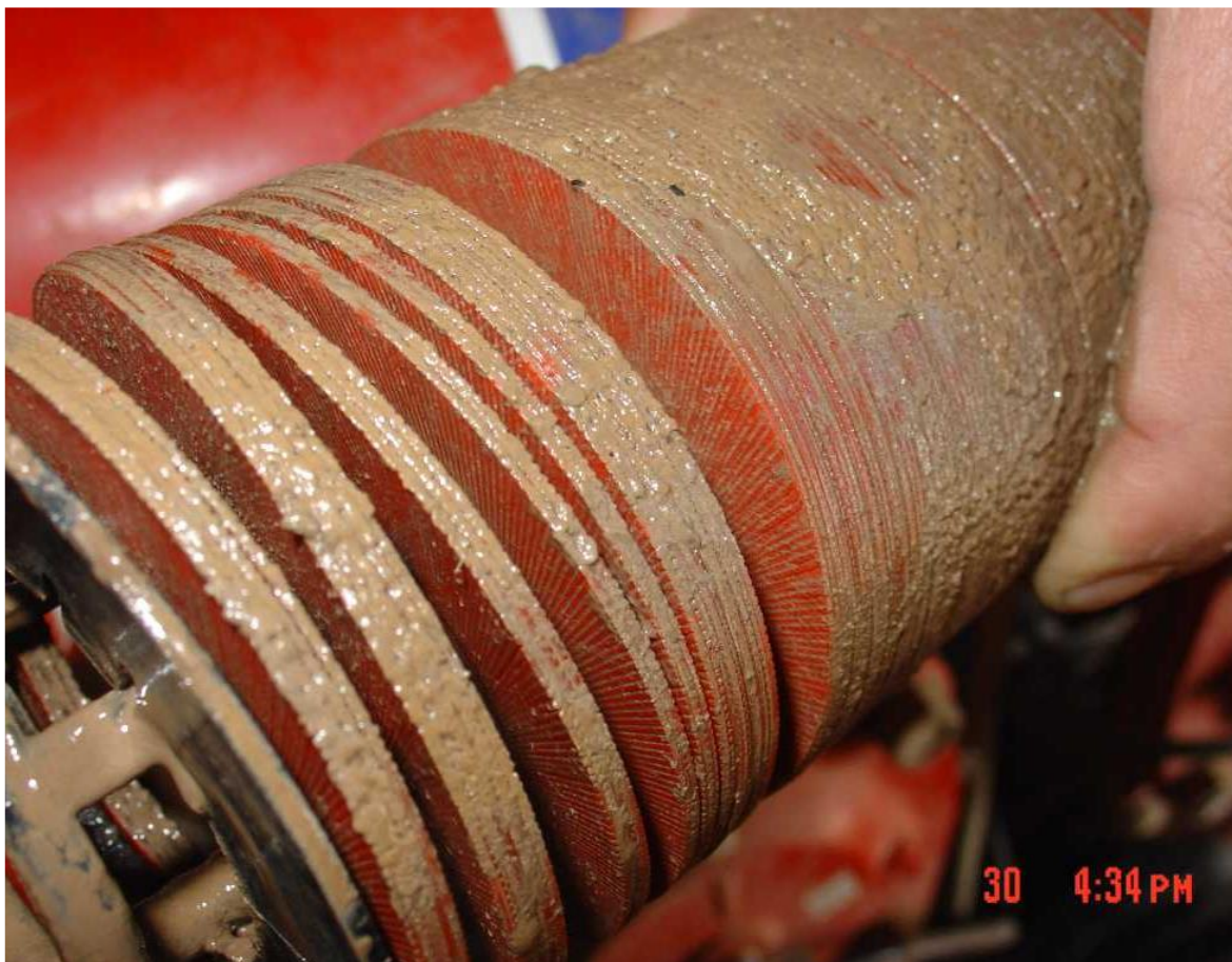
Foto 5. Filtro de anillas sin retrolavado, los sedimentos taponan los canales de paso de agua, disminuyendo la presión de la red.
