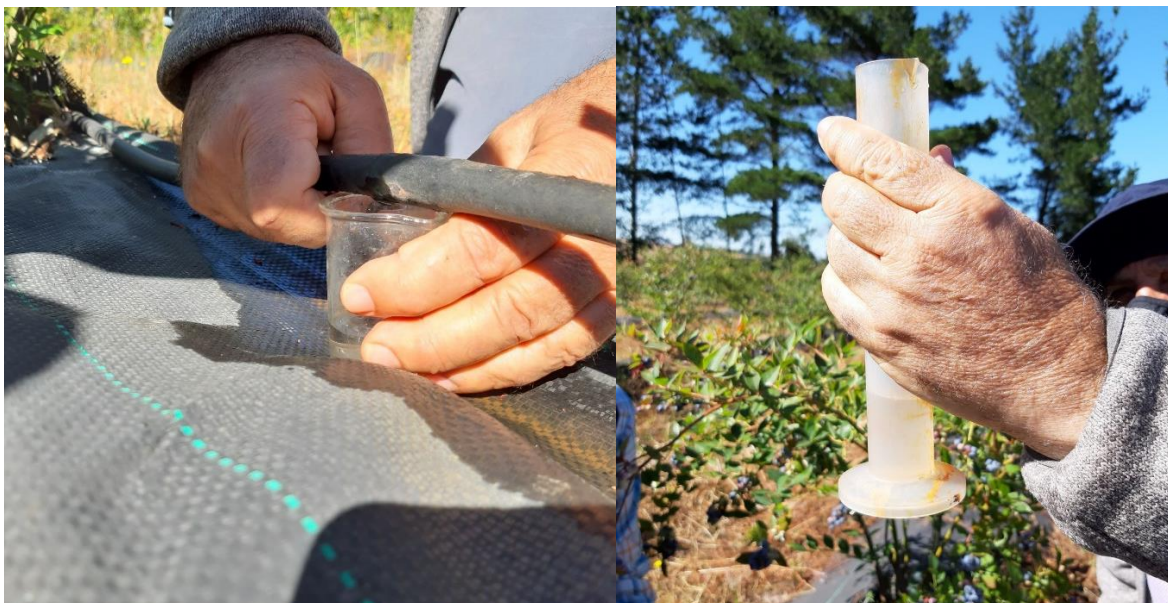
Foto 4. Aforo de goteros.
